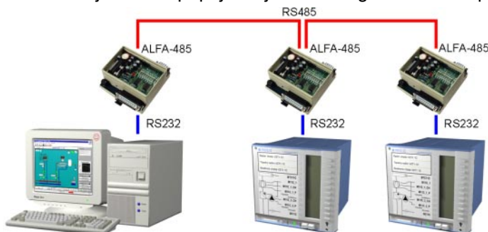
obrázek 1 - připojení stanic RWP na linku RS485
