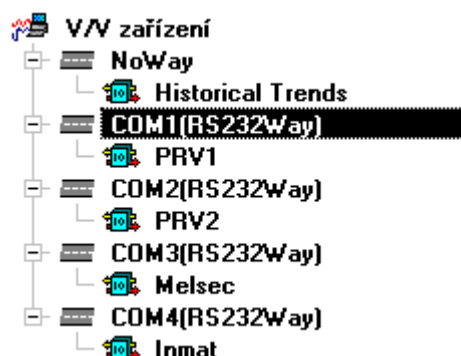
obrázek 20 - Připojení V/V modulů na cesty typu RS232Way
